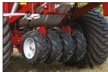
Återpackningen mellan traktorhjulerna görs med en hydrauliskt belastad mellanpackare placerad mellan de stora lågtrycksdäcken.
