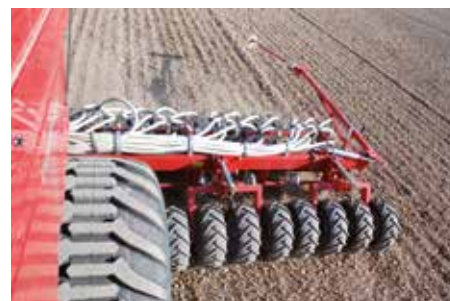
Sidopackare med två, fyra eller åtta mönstrade gummihjul kan monteras per sida för att uppnå fullbreddspackning för 4, 6 resp 8 meters arbetsbredd.
