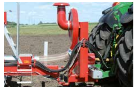
Bäraxeldraget med vridpunkt bakom fläkten gör att maskinen "styr ut" i hömen och följer traktorn smidigt på vändtegen.
