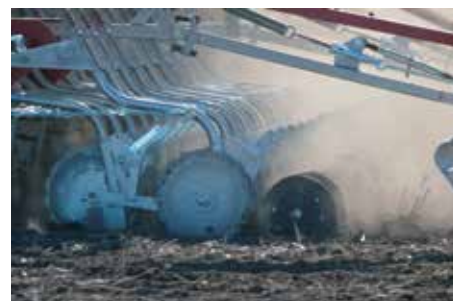
Den individuellt rörliga tandade skivbillen på Multi Jet Disc har en tryckrulle som pressar över såraden. Efterharven efterlämnar en jämn lucker yta.
