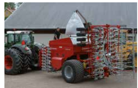
Den fjäderbelastade rull-presenningen och behållarens stora öppning gör fyllningsarbetet mycket smidigt.
