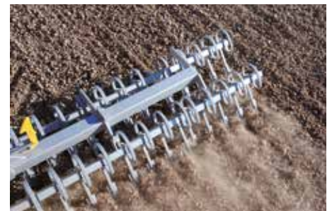
Dubbel Flexplanka bearbetar effektivt hela maskinens arbetsbredd med de hamrande Flexpinnarna.
