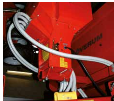
Frösåmaskin för vallinsådd, fånggröda eller spridning av mikrogranulat mot snigelangrepp.
